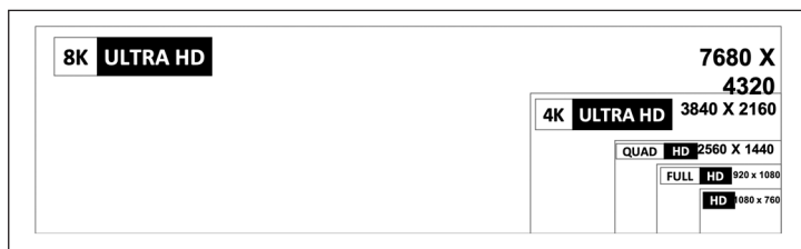
FIG. 5.6. Schema comparativo dei formati di risoluzione video da HD a UHD-8K.
